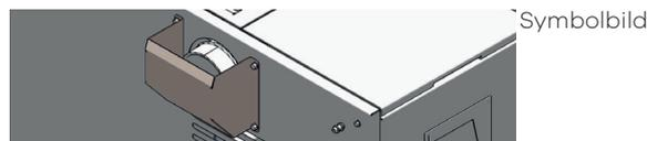
Ein Betrieb ohne Abdeckung oder ohne angeschlossene Konvektionsleitungen ist nicht erlaubt. Missachtung führt zu Gewährleistungsverlust und für Schäden wird keine Haftung übernommen.
