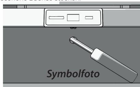
Durch Drehung im Uhrzeigersinn werden die Luftklappen geöffnet, entgegen dem Uhrzeigersinn geschlossen.
