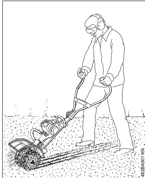
Das MultiWerkzeug Rasenlüfter RL-MM dient zum Belüften von Rasenflächen (vertikutieren).
