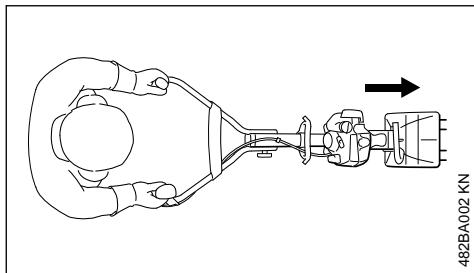
Met de multimotor met gazonbeluchter RL-MM wordt in voorwaartse richting gewerkt.
