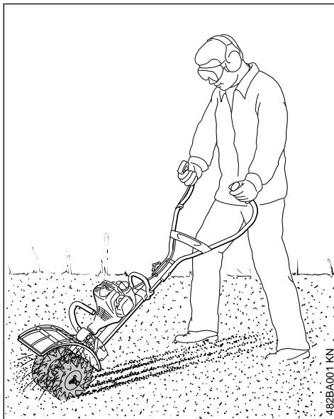
L'outil MultiSystème aérateur RL-MM est conçu pour aérer (scarifier) les surfaces de gazon.
