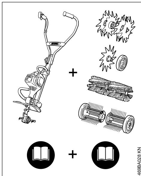
Beim STIHL MultiSystem werden unterschiedliche MultiMotoren und MultiWerkzeuge zu einem Motorgerät zusammengeführt. Die funktionsfähige Einheit von MultiMotor **und** MultiWerkzeug wird in dieser Gebrauchsanleitung Motorgerät genannt.
