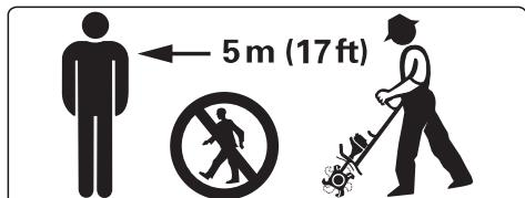
À part l'utilisateur, personne ne doit se trouver dans un rayon de 5 m de la machine en marche – **risque de blessure par des objets projetés, ou en cas de contact avec l'outil de travail !** Respecter aussi cette distance par rapport à des véhicules, des vitres etc. – **risque de dégâts matériels !**
