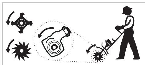
Les flèches marquées sur les couronnes de couteaux indiquent le sens de rotation. Les flèches
