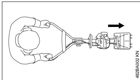
Con il motore Multi dotato dell'arieggiatore RL-MM si lavora avanzando.
