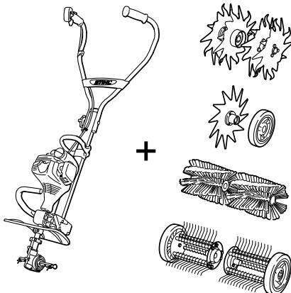
Le MultiSystème STIHL offre la possibilité de combiner différents moteurs MultiSystème et outils MultiSystème pour composer une machine. Dans la présente Notice d'emploi, l'ensemble – en ordre de marche – d'un moteur MultiSystème et d'un outil MultiSystème est dénommé machine ou dispositif à moteur.
