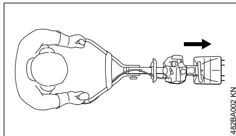
Mit dem MultiMotor mit Rasenlüfter RL-MM wird vorwärts gearbeitet.
