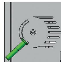
Die Anheizstellung darf ausschließlich zum Entzünden der Scheite beim Anheizen oder Nachlegen verwendet werden.
